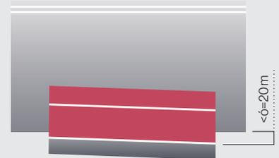
Este nuevo perfil posibilita la instalación de puertas enrollables en las que existe un desnivel del terreno menor o igual a 20 mm entre guías, permitiendo un correcto funcionamiento.
