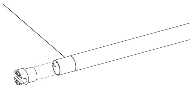
Colocar la tapa al terminal sistema SRS en ambos extremos como se muestra en la imagen.
