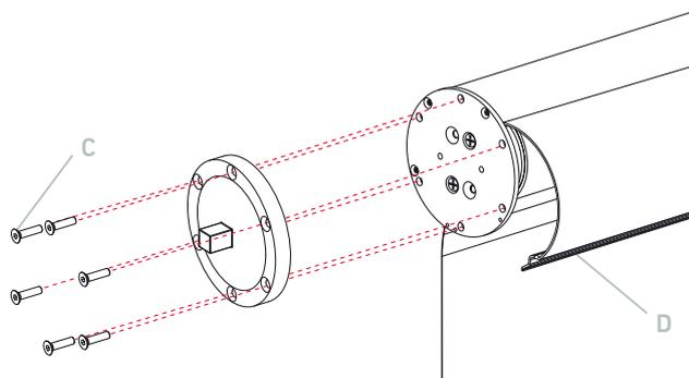
Seguidamente, unir el cajón con la tapa del testero mediante los tornillos **C** y colocar la parte inferior del cajón **D**.
