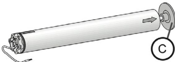
**3.4.1** Montar el conjunto tubo-motor en el soporte del extremo (C).
