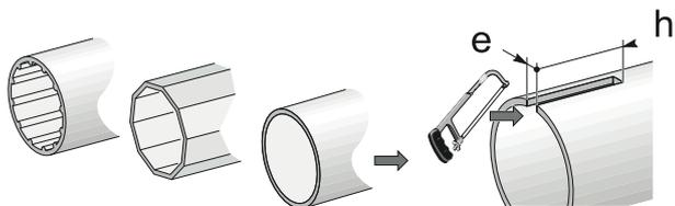
**3.2.3** En tubos lisos, realice una muesca según las dimensiones indicadas: - e = 4 mm - h = 28 mm.
