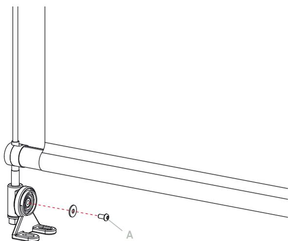
Fijar el cable tensor al soporte mediante el tornillo **A**.
