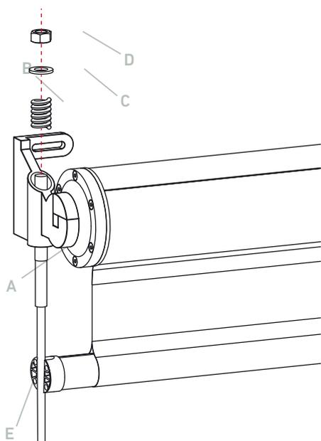
Introducir el cable tensor por los soportes superiores y ajustar y fijar el cable tensor al soporte, para ello colocar el tensor **A**, el muelle **B**, la arandela **C** y tuerca **D**.
