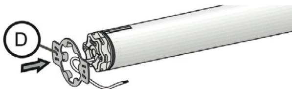
**3.4.2** Monte el conjunto tubo-motor en el soporte del motor (D).
