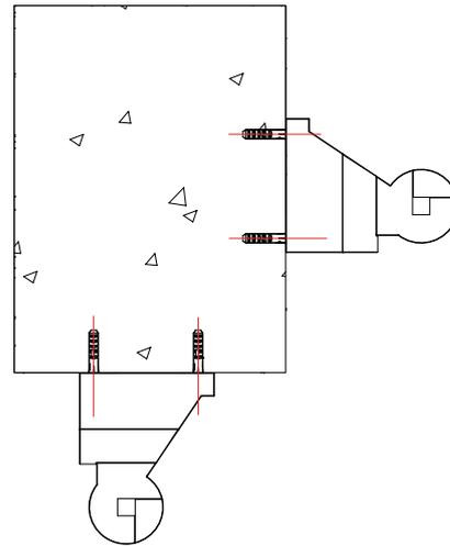
Posicionar los soportes (frontales o a pared) a la distancia correcta. Para ello medir la línea del toldo ensamblado (de soporte a soporte). Ambos soportes deben estar posicionados al mismo nivel.
