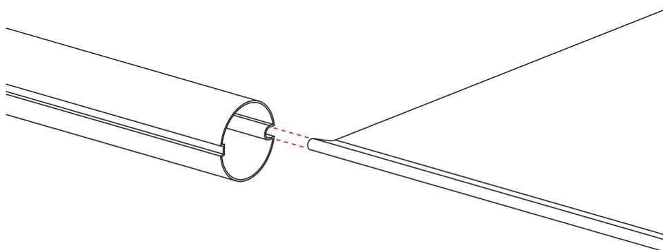
Introducir el tejido en el eje como se muestra en la imagen. Fijar con tacos y tornillos.
