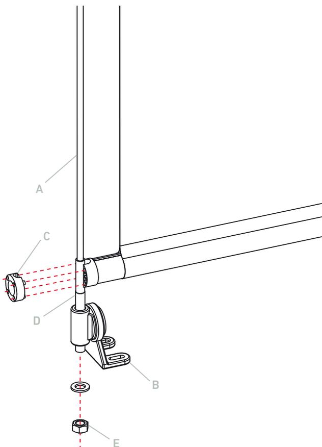
Introducir el cable tensor **A** por el soporte inferior **B** y la tapa del terminal **C**. Fijar al soporte inferior mediante el tensor **D** y la tuerca **E**.
