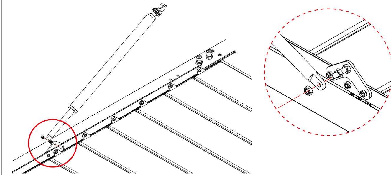
3. Desplazar el motor abriendo la pérgola, hasta que el soporte del mismo se pueda atornillar en los orificios roscados de la viga.
