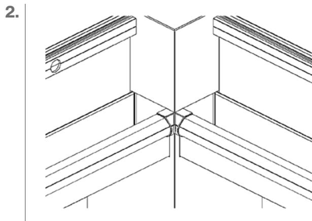
En las **esquinas de la pérgola con inglete**, colocar la pieza para la esquina de LED perimetral que aparece en la imagen a la derecha.
