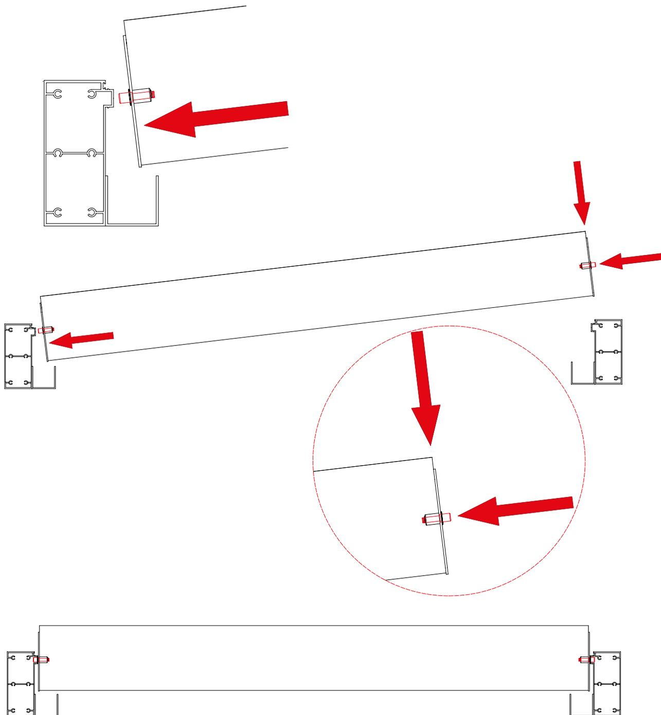
Cuando se llegue al orificio donde van las lamras con LED realizar la conexi3n del conector e introducirlo en el interior de la viga (como se muestra en las im3genes posteriores).
