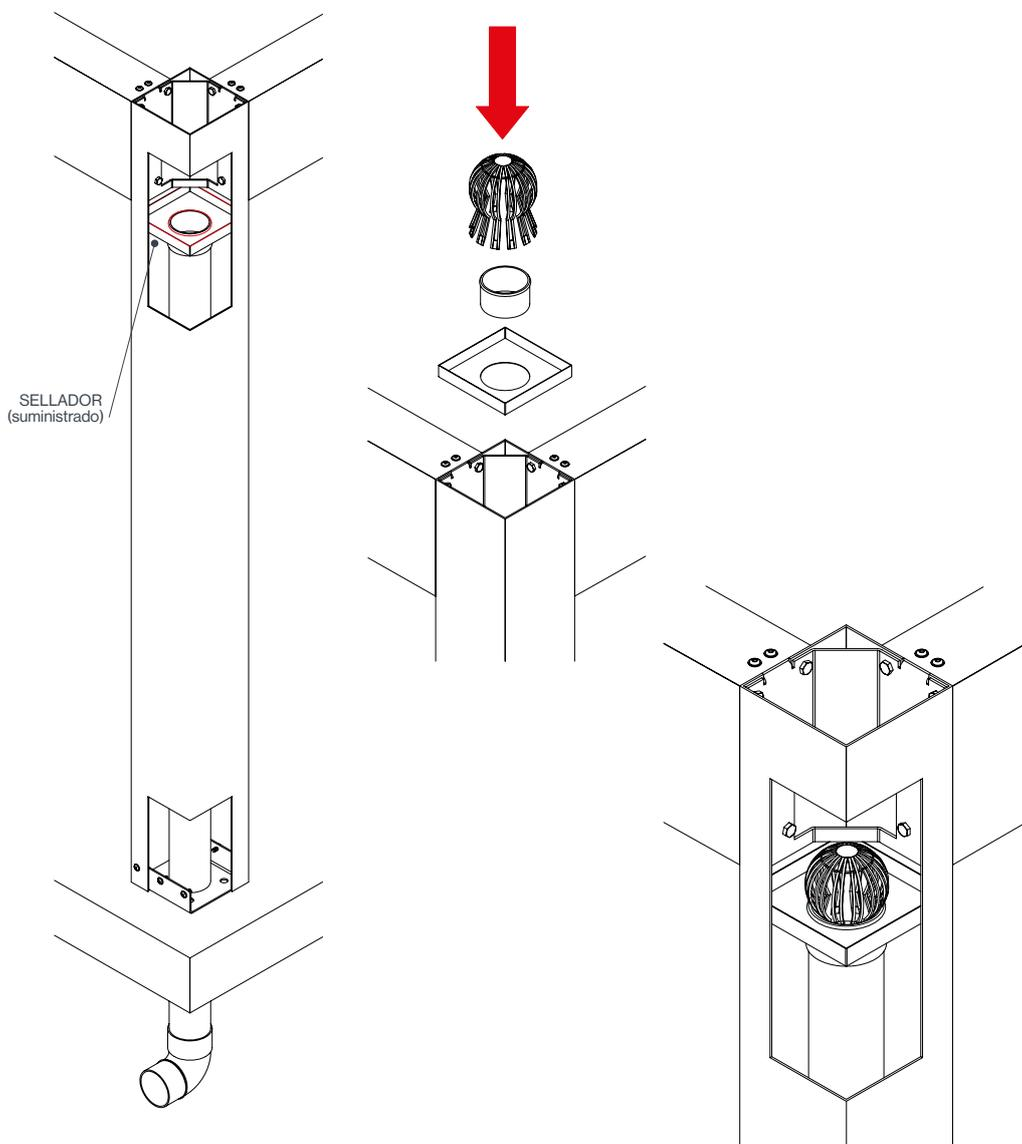
Para terminar, aplicar el sellador (suministrado) por todo el perímetro de la bandeja recolectora y del adaptador. Como se muestra en la imagen (sellador en rojo) e introducir en el adaptador el parachoques universal.
