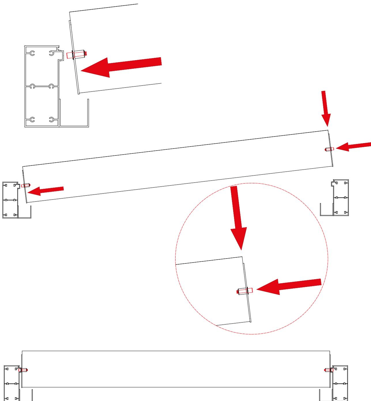
Cuando se llegue al orificio donde van las lamas con LED realizar la conexión del conector e introducirlo en el interior de la viga (como se muestra en las imágenes posteriores).
