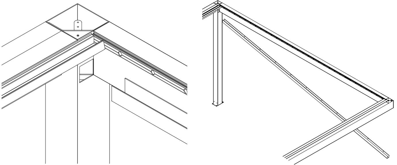
Comprobar que todos los orificios del perfil "U" coinciden con los mecanizados de M6 de las vigas. Si todos coinciden, aplicar sellador entre el perfil "U" y la viga, después atornillar los perfiles por medio de los tornillos ULS (ISO 7380) A2 M6x16.
