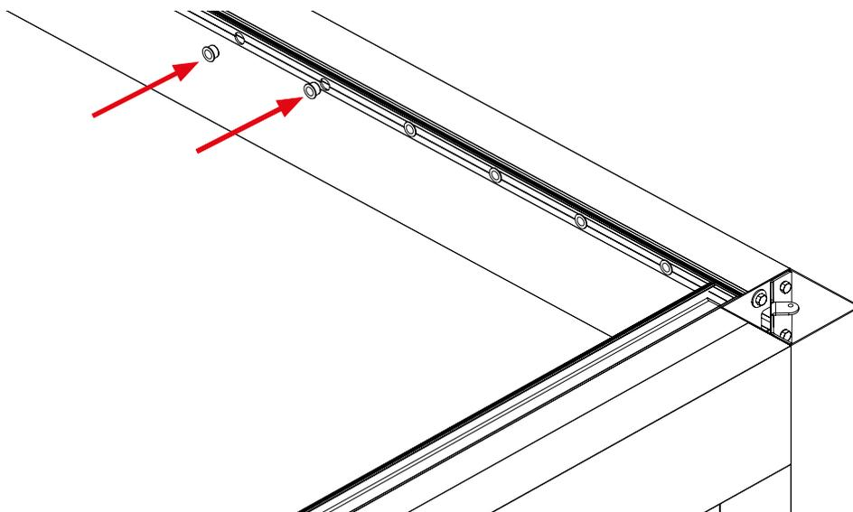
Para instalar las lamas sin LED, dispondremos de juegos de casquillos sistema pivote O-210, formados por un casquillo plástico de 16,4x25 mm, y un eje de acero inoxidable retráctil.
