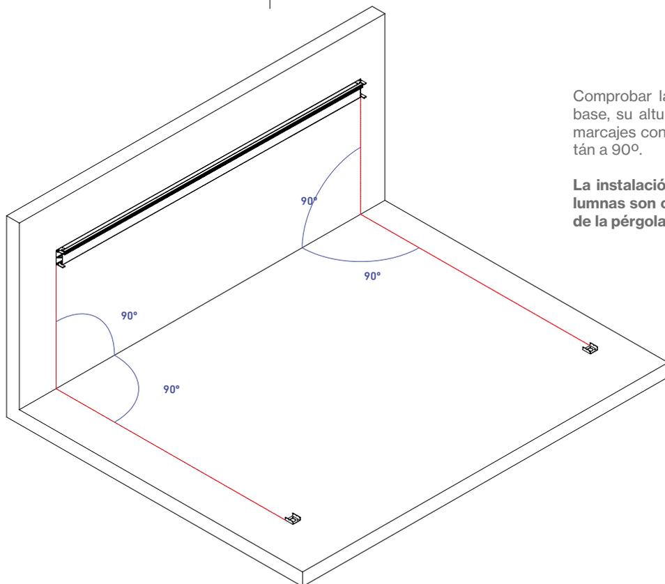
Comprobar la nivelación de la viga con respecto a la base, su altura con respecto al plano y que todos los marcajes con respecto a las fijaciones de las bases están a 90°.
