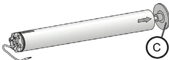
**2.4.1** Montar el conjunto tubo-motor en el soporte del extremo (C).
