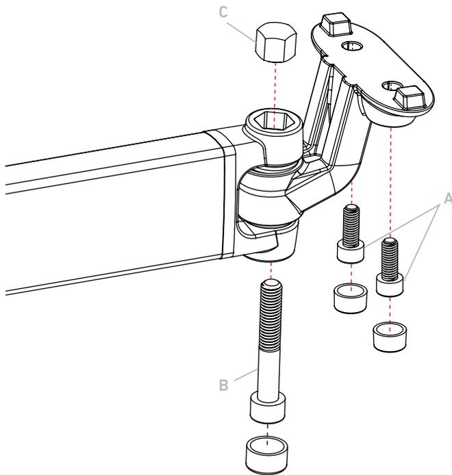
Insertar los dos tornillos Allen **A** de la regleta por los orificios del terminal y sujetarlos a la citada regleta.
