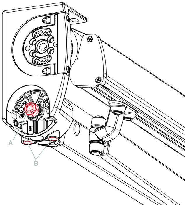
Para nivelar la inclinación de los brazos, aflojar ligeramente la tuerca **A** y actuar con una llave Allen del 7 mm sobre los tornillos de regulación **B** que tiene este soporte.
