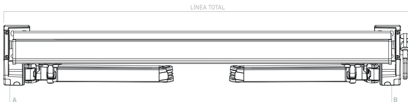
Cuando colocamos los soportes a sujeción frontal **A** o a techo **B**, y la máquina por el exterior, la línea total se determina de soporte a extremo de máquina.
