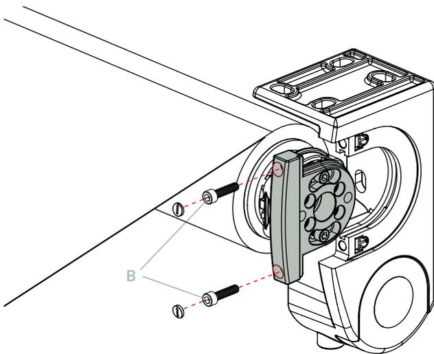
Colocar en el otro soporte el guía máquina con la misma colocada o el soporte motor e igualmente sujetar con los tornillos correspondientes **B**, a las tuercas insertadas en el soporte.
