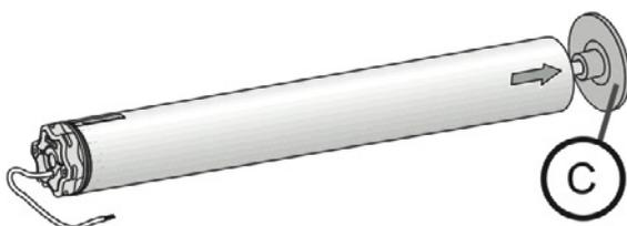
**3.4.1** Montar el conjunto tubo-motor en el soporte del extremo (C).
