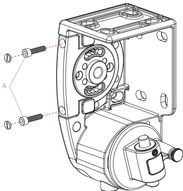
Colocar en uno de los soportes el guía punta, sujetándolo con los tornillos **A** que se sujetan en las tuercas ya insertadas en el propio soporte.
