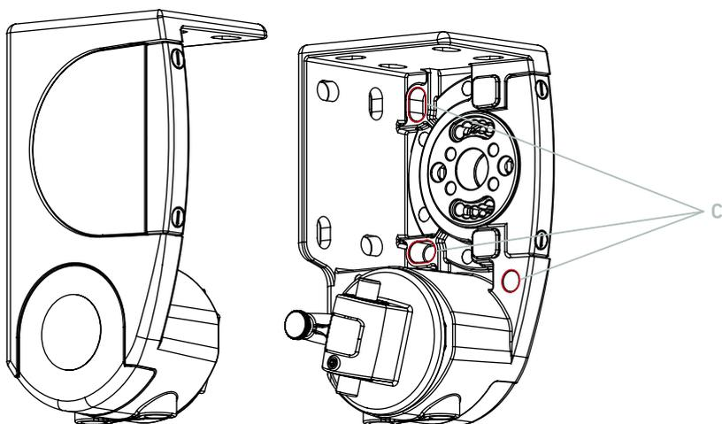
Cuando la fijación se desea entre paredes, deben perforarse los agujeros premarcados en el soporte **C** e introducir los correspondientes anclajes.
