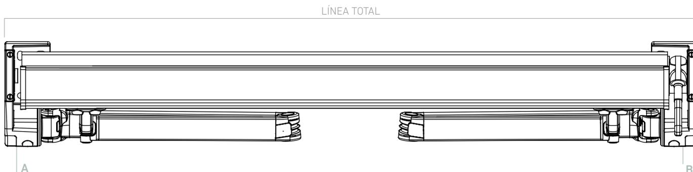
Cuando colocamos los soportes a sujeción frontal **A** o a techo **B**, y la máquina (o motor) por el interior, la línea total se determina de soporte a soporte.
