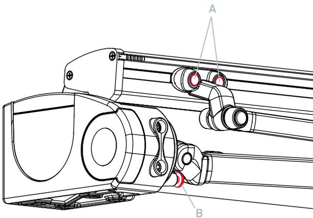
Una vez hecho esto, cerrar el toldo completamente y apretar los tornillos Allen **A** de ensamble entre el terminal y la regleta.
