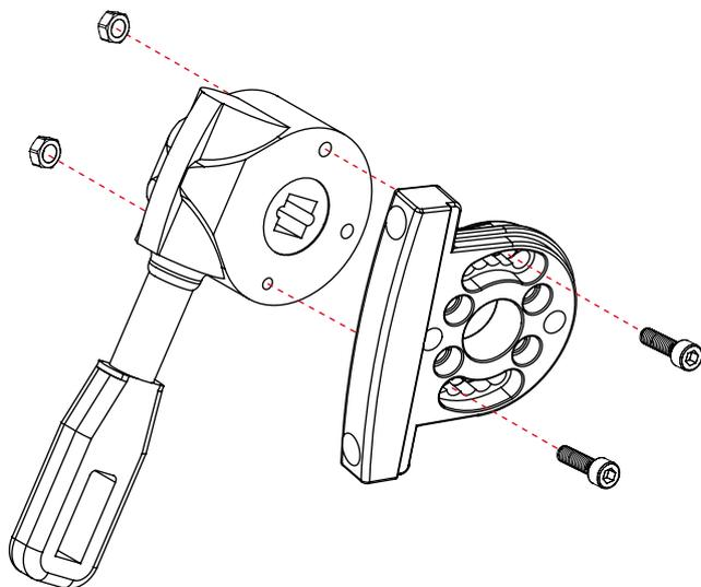
Recordar que las tuercas van siempre por la parte de la guía máquina, y los tornillos por el lado contrario.
