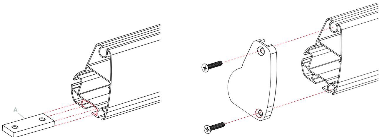
Insertar en la ranura inferior del perfil delantero **TOLPER** la regleta **A** que sujetará el terminal.
