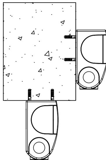
Posicionar los soportes (frontales o a pared) a la distancia correcta. Para ello medir la línea del toldo ensamblado (de soporte a soporte). Ambos soportes deben estar posicionados al mismo nivel.
