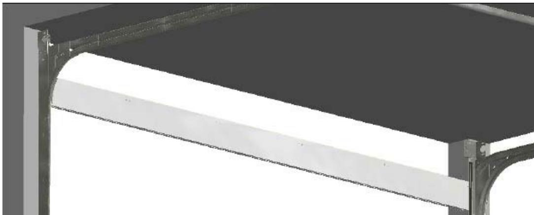
Realizar el orificio en la Lama Celosía R4-200 de código: 050482 o la Lama Celosía R4-300 de código: 050440 en la posición del orificio de la Placa de Unión Eje Izquierdo/Derecho RSC de códigos: 039179 y 039180 respectivamente, con una broca de  $\varnothing 9\text{mm}$ . Introducir la Tuerca Remachable M6 Aluminio de código: 051257 y fijar el dintel 200/300 por medio de los Tornillos DIN 912 A2 M6x25 Allen de código: 905609 con la Arandela DIN 9021 A2 6,4 M6 Ancha de código: 039123.
