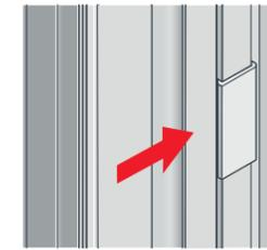
7.2 Cuando la mosquitera está cerrada, el anclaje está enganchado en la barra deslizante y la barra deslizante se retira hacia el perfil de pliegue de la tela firmemente.
