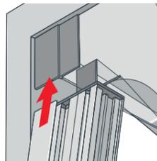
5.2 Inserte la mosquitera y la guía lateral (unidos ambos con el imán) dentro de la guía superior. La guía lateral debe insertarse en el hueco en donde el testero más grande de la guía superior y situar la parte inferior de la mosquitera sobre la guía fija inferior.
