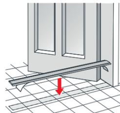
4.2 Retire la cinta blanca de la cinta doble cara y presiónela al suelo fuertemente en línea con la línea marcada. Asegúrese de presionarla hacia el lado del perfil del pliegue de la tela y tenga en cuenta que hay más de 7,5 mm de espacio en cada lado de la guía lateral.
