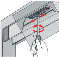
**Nota:** ajustar la tensión del hilo situado en la parte central del regulador. Hay que tener en cuenta que demasiada tensión en el hilo puede provocar un mal funcionamiento de la mosquitera.
