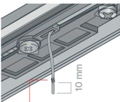
**Nota:** asegúrese de que el regulador de hilo no está instalado en el tornillo de carril superior. En caso de que fuese así y no pueda evitarlo, corte el hilo y haga un doble nudo dejando unos 10 mm en el extremo del hilo tal y como se muestra en esta imagen.
