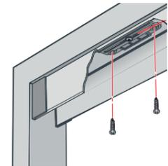
**9.3** Los tornillos de fijación asegurarán la correcta posición del regulador de hilo sobre el perfil.
