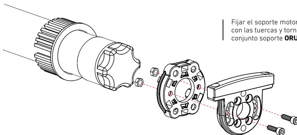
Fijar el soporte motor, tal y como se observa en la imagen con las tuercas y tornillos directamente sobre el lateral del conjunto soporte **ORUS**, y dejándolo fuertemente sujeto.
