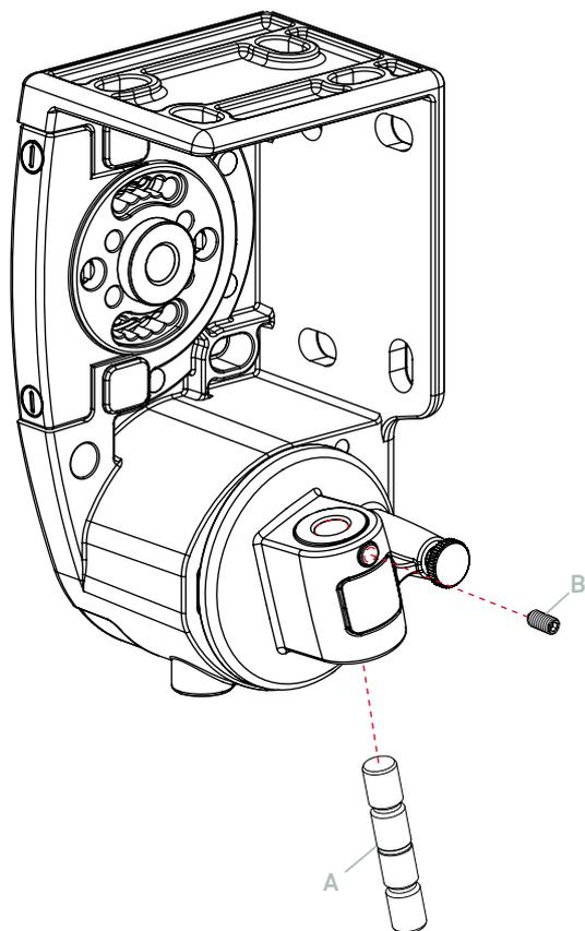
Con el tejido prácticamente enrollado en el tubo, sacar el vástago de sujeción de la horquilla del brazo.
