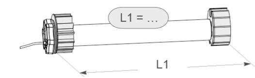
**3.1.2** Medir la longitud (L1) entre el borde interior de la cabeza del motor y el extremo de la rueda.
