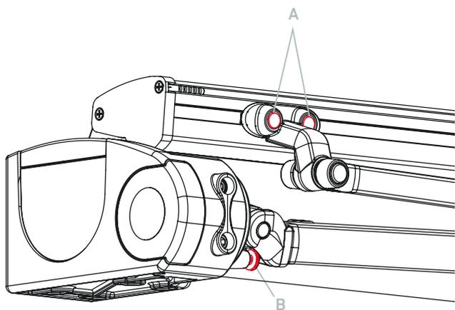
Una vez hecho esto, cerrar el toldo completamente y apretar los tornillos Allen **A** del ensamble entre el terminal y la regleta.
