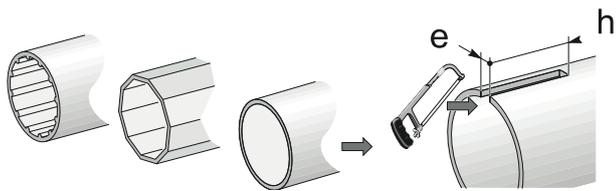
**3.2.3** En tubos lisos, realice una muesca según las dimensiones indicadas: - e = 4 mm - h = 28 mm.
