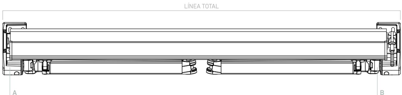
Cuando colocamos los soportes a sujeción frontal **A** o a techo **B**, y la máquina (o motor) por el interior, la línea total se determina de soporte a soporte.
