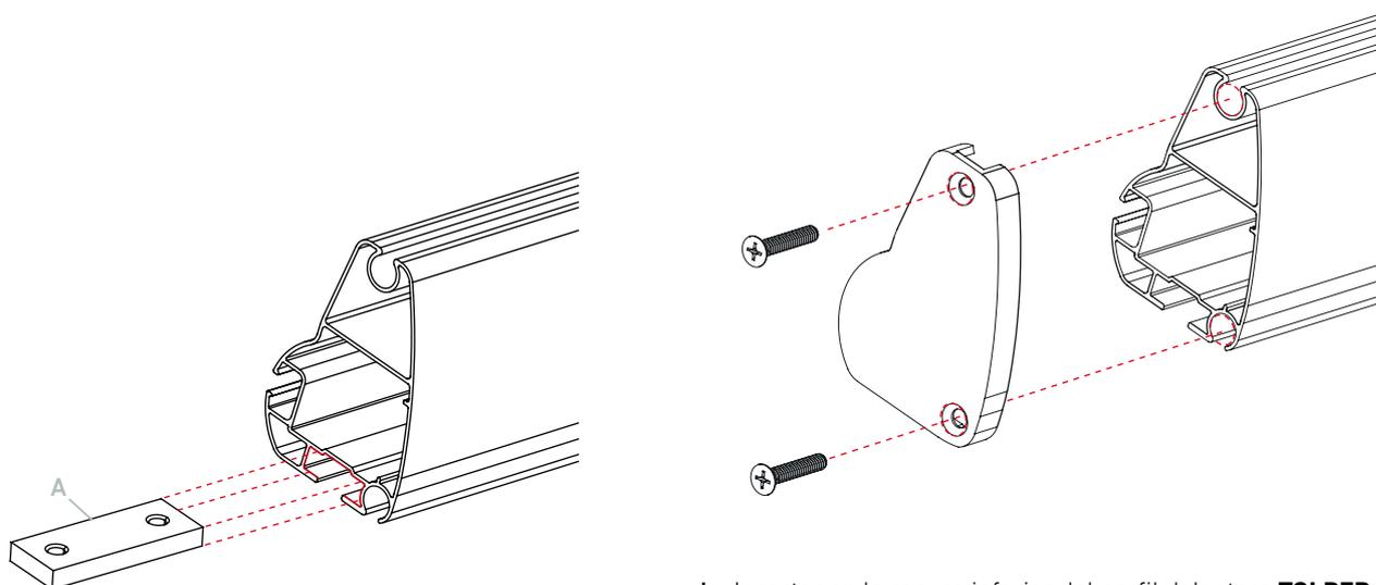
Insertar en la ranura inferior del perfil delantero **TOLPER** la regleta **A** que sujetará el terminal.
