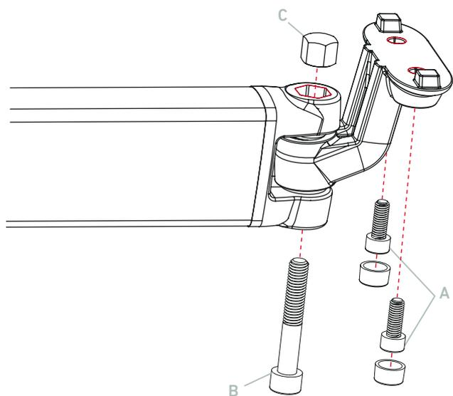
Insertar los dos tornillos Allen **A** de la regleta por los orificios del terminal y sujetarlos a la citada regleta.
