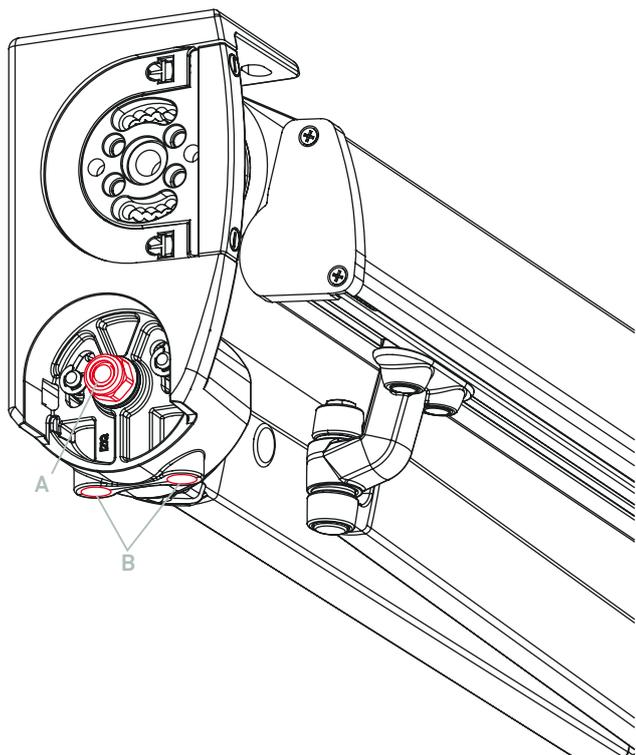
Para nivelar la inclinación de los brazos, aflojar ligeramente el tornillo **A** y actuar con una llave Allen del 7 mm sobre los dos tornillos **B** de doble regulación que tiene este nuevo soporte.
